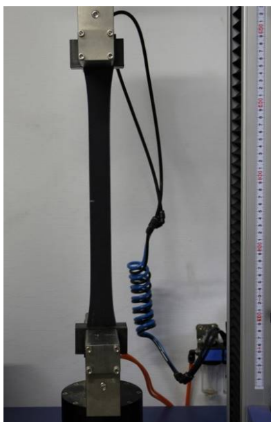
Photo 10 – Test de traction Cisaillement sur mat. 1ère
