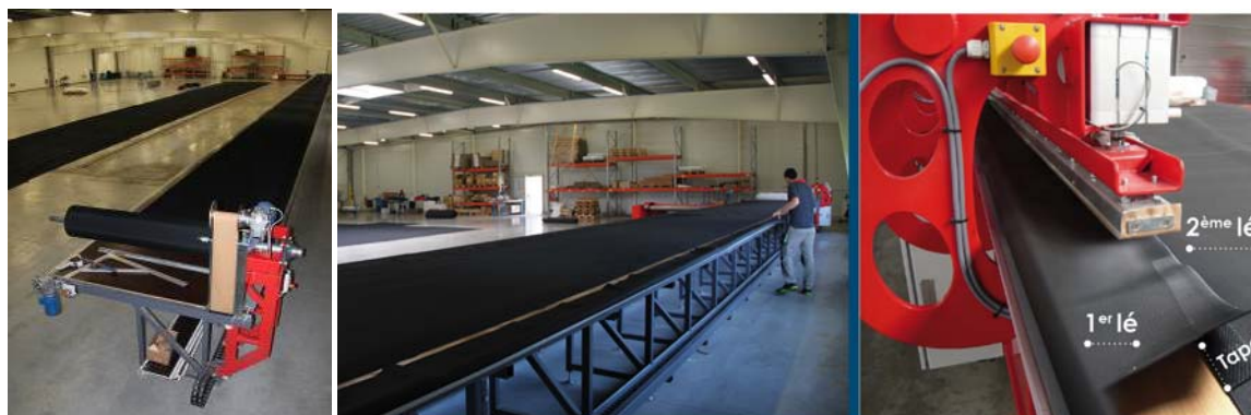
Photo 8 - Zone de préfabrication et presses pour vulcanisation des joints en 2D
