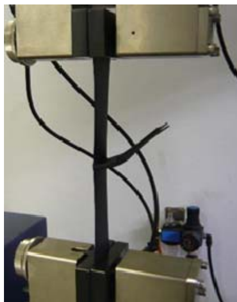
Photo 11 – Test de traction Pelage sur joint vulcanisé
