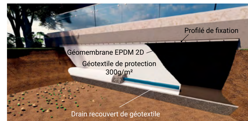
Pose d'une géomembrane EPDM 2D pour protection de soubassement
