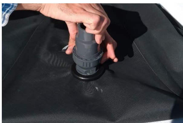
5. Positionner le corps de la vanne, poignée vers le haut
