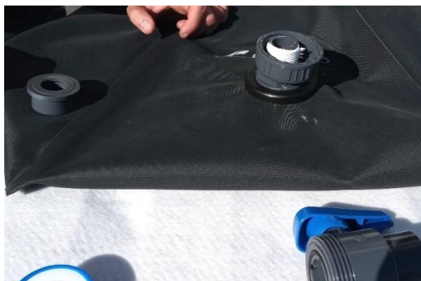
3. Placer la grande bague autour de l'axe fileté
